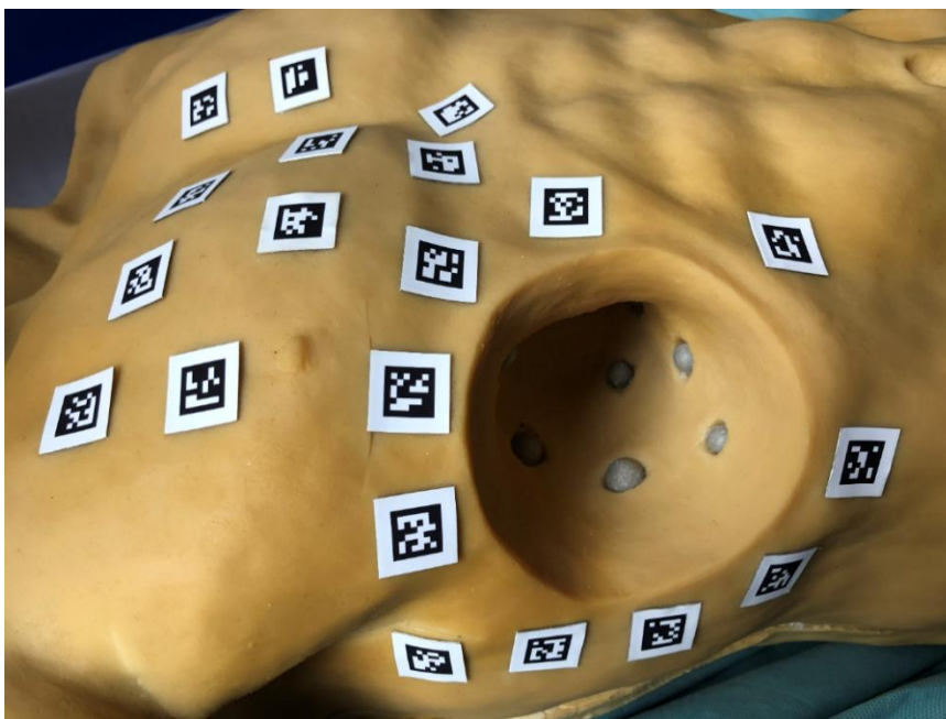
Figura 1: esempio di posizionamento del Patient fiducial - Marker kit su un fantoccio. Il foro rappresenta l'area che presumibilmente includerà il punto di ingresso dell'ago.
