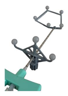
Far scorrere l'ago nella clip distale del Needle fiducial – Sensor IR fino a quando una piccola parte della punta dell'ago è visibile sul fondo della clip distale del Needle fiducial – Sensor IR. Si consiglia di posizionare la clip distale del Needle fiducial - Sensor IR sul paziente al fine di identificare la migliore traiettoria di ingresso e di utilizzare aghi rigidi (introduttori) al fine di evitare la flessione dell'ago durante l'inserimento.
